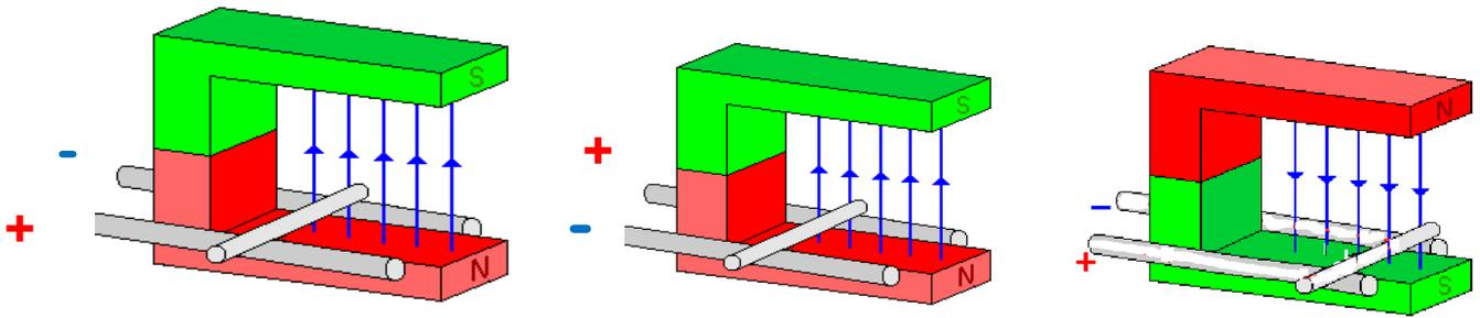
Je nachdem in welcher Richtung der Strom (Wir zeichnen die technische Stromrichtung) durch die Querstange fließt, wirkt die Kraft auf diese Stange nach rechts oder nach links.
