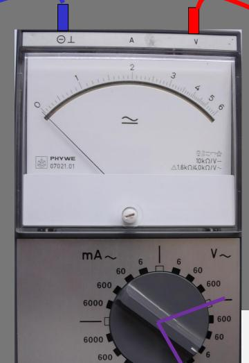
Anschluss für den +Pol wenn du Spannungen messen willst. V steht für Volt
