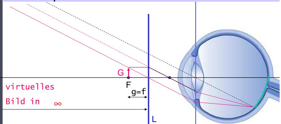
Um ein völlig entspanntes Auge zu haben, muss G im Brennpunkt stehen. Dann liegt der Brennpunkt der Augenlinse genau auf der Netzhaut.
