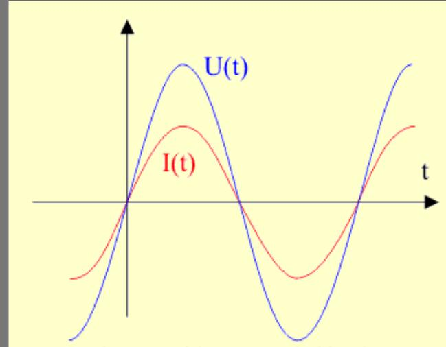
Bei sinusförmiger Spannung  $U(t) = \hat{U} \cdot \sin(\omega \cdot t)$  (1) gilt:
