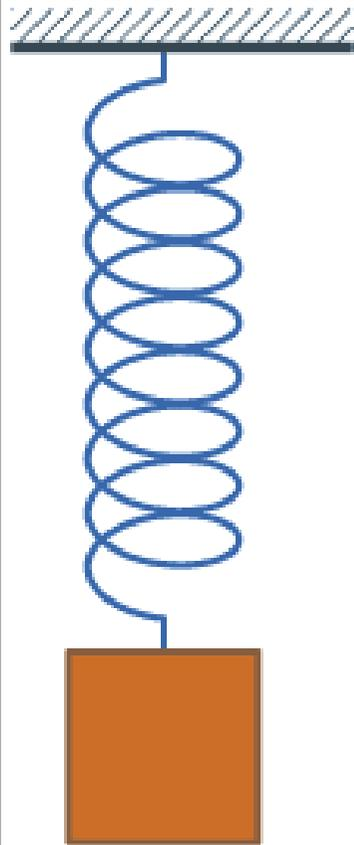
Eine **Schwingung** ist eine Zustandsänderung eines Masseteilchens bzw. eines Systems von Masseteilchen bei der das System durch eine rücktreibende Kraft immer wieder in Richtung des Ausgangszustandes gezwungen wird.
